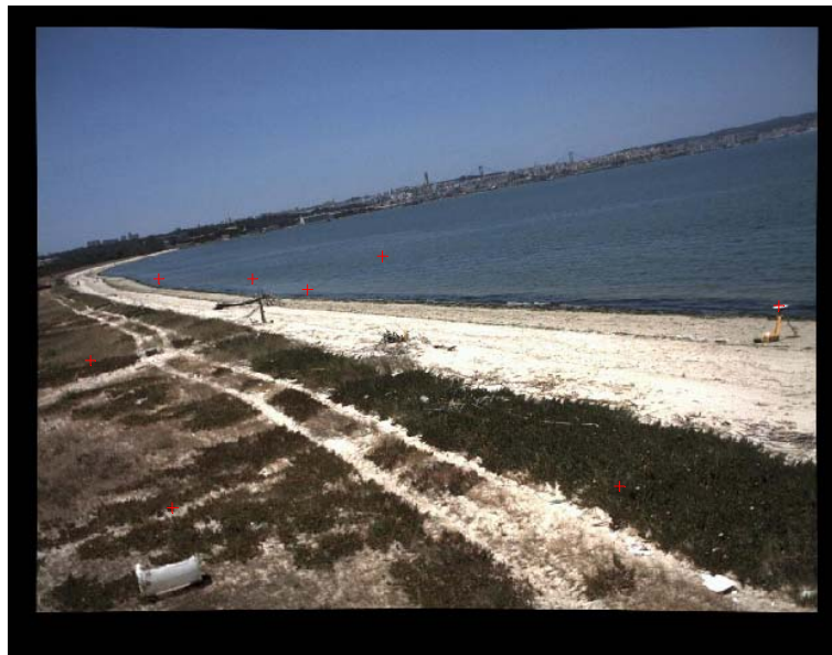
Figura IV. 8 – Imagem corrigida dos efeitos de distorção da lente, com a localização dos GCP coordenados (a vermelho).
