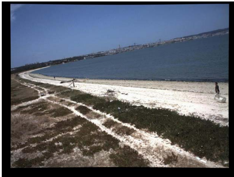
Figura IV. 17- Imagem corrigida dos efeitos de distorção da lente, adquirida quando o nível de maré se encontrava a cerca de 0.6 m, relativamente ao nível médio do mar.
