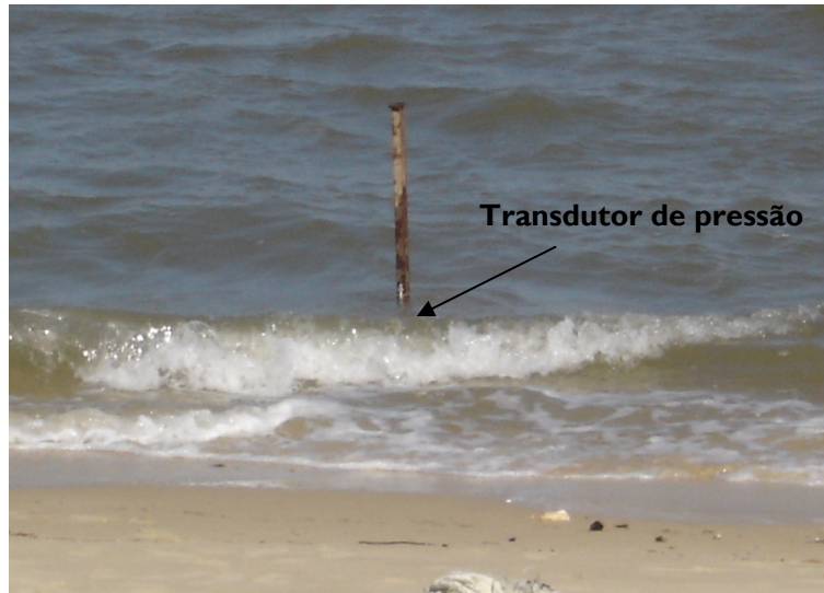
Figura IV. 11- Transdutor de pressão colocado dentro de água para a determinação do nível de maré.
