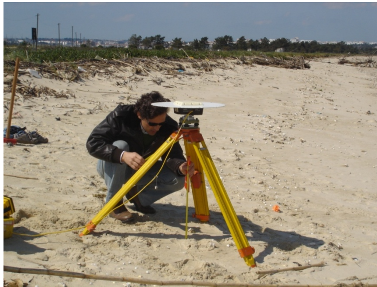
Figura IV. 6 – Levantamento topográfico com GPS dos pontos de controlo (GCP), necessários à rectificação das imagens.
