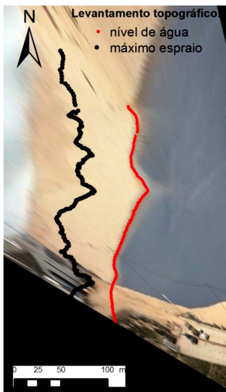
Figura III. 11 - Imagem corrigida utilizando o nível de água da laguna, com a implementação dos pontos levantados com DGPS.
