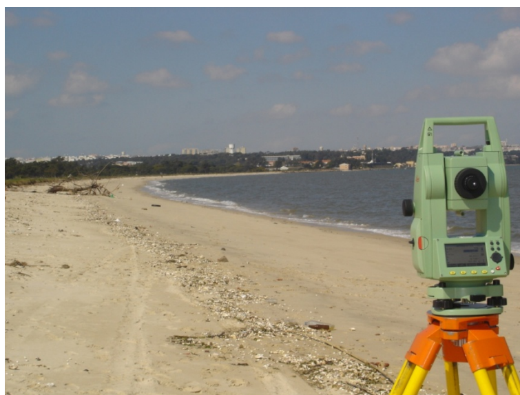
Figura IV. 9- Levantamento topográfico da área visível nas imagens com recurso a uma estação total.
